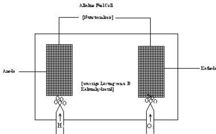
Die AFC besteht aus einem Behälter, welcher mit einer wässrigen Kaliumhydroxidlösung gefüllt ist. In diese Lösung tauchen zwei Elektroden ein, die Kathode und die Anode. Diese sollten eine große Oberfläche besitzen, um eine gute Absorption der „Brennstoffgase“ zu ermöglichen.
